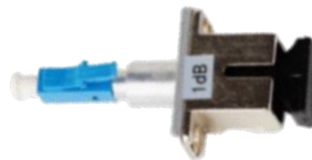
Número de parte: MA-F-S-SLF-0010-M-M3. Atenuador mecánico monomodo hembra a macho de valor fijo de 1dB, SC/UPC a LC/UPC.
